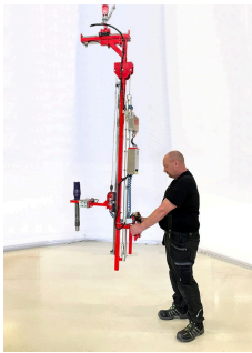
Manhattan đầu nâng cửa ô-tô Giác hút · nâng + nghiêng · tải 30 kg
