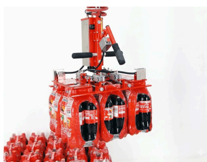
Kẹp kết chai PET 3533 Tùy chỉnh để nâng kết 24 chai PET (1,5 L) bọc nhựa. Cho ngành đồ uống. Kết 24 chai · 1.5 L · Mã: 3533
