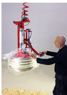
Kẹp vỏ xúc xích 89-12142 Tùy chỉnh để nâng cuộn vỏ nhân tạo cho sản phẩm thịt. Nâng tới 50 kg công thái học. Tải: 50 kg · Ngành thịt · Mã: 89-12142
