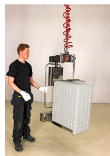
Kẹp khay dược phẩm 89-10861 Tùy chỉnh để nâng khay trong phòng sạch tiêu chuẩn cao nhất – ngành dược. Phòng sạch · Ngành dược · Mã: 89-10861
