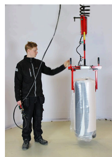
Kẹp đệm cuộn 89-11892 Tùy chỉnh để nâng đệm cuộn từ vị trí ngang sang vị trí dọc. Đệm cuộn · Lật ngang↔dọc · Mã: 89-11892
