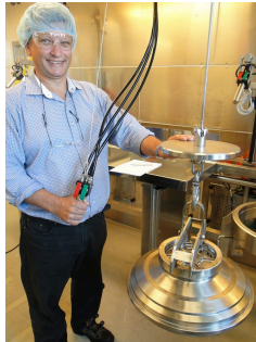
Kẹp dược phẩm 89-10059 Bàn tùy chỉnh tích hợp hai đầu kẹp để xử lý dược chất trong phòng sạch cấp cao. Bàn 2 đầu kẹp · Phòng sạch · Mã: 89-10059
