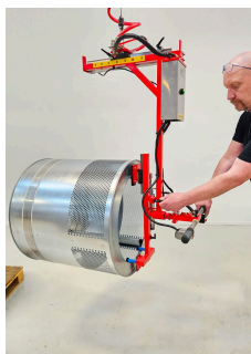
Kẹp lồng máy giặt 89-12413 Thiết kế để đơn giản hóa việc xử lý lồng máy giặt hàng ngày. Lồng máy giặt · Cơ khí · Mã: 89-12413
