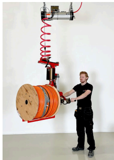
Kẹp cuộn lõi sợi 89-12258 Nâng và nghiêng cuộn cáp quang hoặc cuộn lõi tới 40 kg dễ dàng. Tải: 40 kg · Cuộn cáp · Mã: 89-12258
