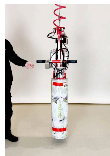
Kẹp Cuộn 89-12155 Nâng cuộn tới 40 kg, cả phương ngang lẫn phương dọc. Đầu kẹp cơ khí linh hoạt. Tải: 40 kg · Ngang & dọc · Mã: 89-12155
