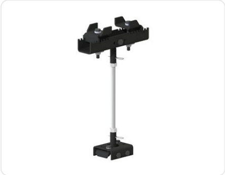
Móc treo I-Beam dạng thanh kéo dài có quả cầu (cánh dầm 2"-7") MRHS40471 Móc treo điều chỉnh chiều cao cho tải trực tiếp. Treo các hệ ray RAD4110/RAD6110/RAD7510. Cánh dầm hỗ trợ: 51-178mm. Độ dày tối đa cánh I-Beam: 7/16" (11mm). Bao gồm 1ft thanh ren, 2 đai ốc khóa và 2 kẹp lò xo. Trọng lượng: 4,63 kg [10,2 lbs] RAD4110 · RAD6110 · RAD7510
