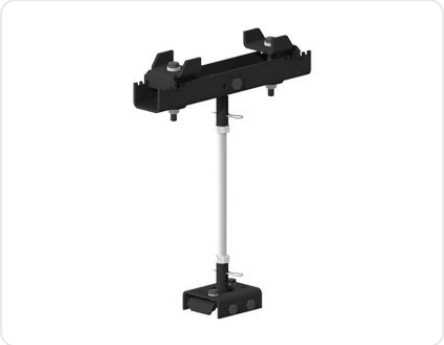
Móc treo I-Beam dạng thanh kéo dài có quả cầu (cánh dầm 7"-11") MRHS40511 Móc treo điều chỉnh chiều cao cho tải trực tiếp. Cánh dầm hỗ trợ: 178-279mm. Độ dày tối đa cánh I-Beam: 7/16". Bao gồm thanh ren 1ft, 2 đai ốc khóa và 2 kẹp lò xo. Phủ chống ăn mòn thân thiện môi trường (Autophoretic ACC 900®). Trọng lượng: 5,13 kg [11,3 lbs] RAD4110 · RAD6110 · RAD7510
