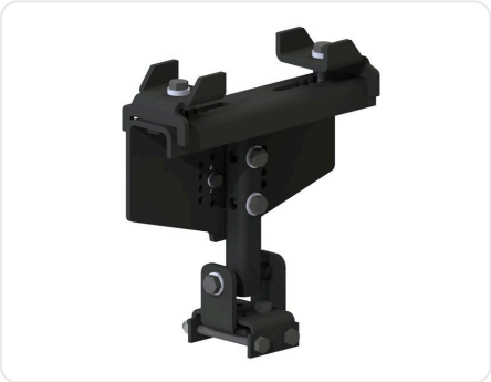
Móc treo I-Beam (cánh dầm 2"-7") MRHS40384 Dùng cho tải trực tiếp hoặc tải lệch tâm. Khả năng điều chỉnh dọc lên đến 50,8mm (bước 6,35mm). Cánh dầm hỗ trợ: 51-178mm. Độ dày cánh I-Beam tối đa: 5/8" . Cấu trúc thép có thể chạy vuông góc hoặc song song với hệ ray Knight. Trọng lượng: 6,33 kg [13,9 lbs] RAD4110 · RAD6110 · RAD7510
