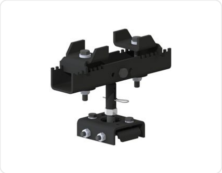
Móc treo I-Beam dạng thanh có quả cầu (cánh dầm 2"-7") MRHS40361 Móc treo điều chỉnh chiều cao cho tải trực tiếp. Cánh dầm: 51-178mm. Độ dày tối đa cánh I-Beam: 7/16". Bao gồm 1 đai ốc khóa và 1 kẹp lò xo. Tùy chọn dây cáp an toàn RWA4133. Trọng lượng: 4,17 kg [9,2 lbs] RAD4110 · RAD6110 · RAD7510
