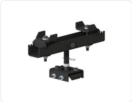
Móc treo I-Beam dạng thanh có quả cầu (cánh dầm 7"-11") MRHS40431 Móc treo điều chỉnh chiều cao cho tải trực tiếp. Cánh dầm hỗ trợ: 178-279mm. Độ dày tối đa cánh I-Beam: 7/16". Bao gồm 1 đai ốc khóa và 1 kẹp lò xo. Trọng lượng: 4,54 kg [10,0 lbs] RAD4110 · RAD6110 · RAD7510
