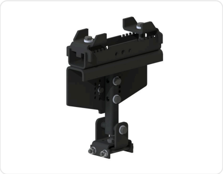
Móc treo I-Beam dạng kéo dài (cánh dầm 2"-7") MRHS40385 Dùng cho tải trực tiếp hoặc tải lệch tâm. Khả năng điều chỉnh dọc lên đến 50,8mm (bước 6,35mm). Cánh dầm hỗ trợ: 51-178mm. Độ dày cánh I-Beam tối đa: 7/16". Phủ chống ăn mòn Autophoretic ACC 900®. Trọng lượng: 7,75 kg [17,1 lbs] RAD4110 · RAD6110 · RAD7510
