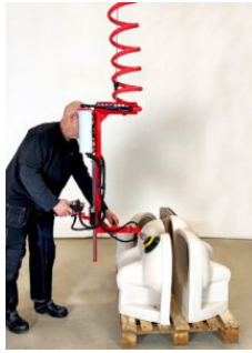
Kẹp sứ vệ sinh 89-12030 Nâng thiết bị vệ sinh bằng sứ: bồn cầu, bidet, lavabo. An toàn và công thái học. Bồn cầu/lavabo · Sứ vệ sinh · Công thái học · Mã: 89-12030
