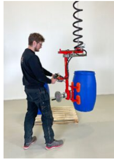
Kệ phuy có Equalizer 89-12313 Bộ Equalizer cho thao tác chính xác. Nâng và đổ thùng phuy nặng ổn định, công thái học. Equalizer · Nâng & đổ phuy · Chính xác cao · Mã: 89-12313
