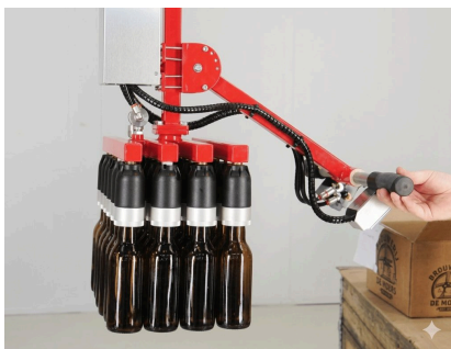
Kẹp Chai 89-10638 Nâng và di chuyển nhiều chai cùng lúc cho ngành đồ uống. Tùy chỉnh theo nhu cầu. Nhiều chai/lần · Ngành đồ uống · Tùy chỉnh · Mã: 89-10638
