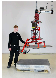
Kệ tấm kim loại 5947 Nâng tấm kim loại cảm giác không trọng lượng, có thể nghiêng tấm. Linh hoạt, tùy chỉnh theo nhu cầu. Tấm kim loại · Nghiêng tấm · Linh hoạt · Mã: 5947
